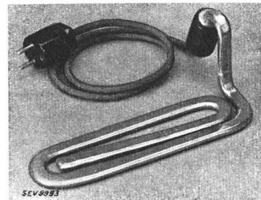
**Beschreibung:** Elektrischer Tauchsieder gemäss Abbildung, für Instrumenten-Sterilisierapparat bestimmt. Widerstandsdraht in Metallrohr von 7 × 14 mm Querschnitt. Netzanschluss mit dreiadrigem, mit 2 P + E-Stecker versehener Rundschnur.
