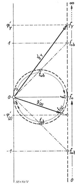
Fig. 4. Reduziertes Vektordiagramm für Serie- und Parallelkreise.
