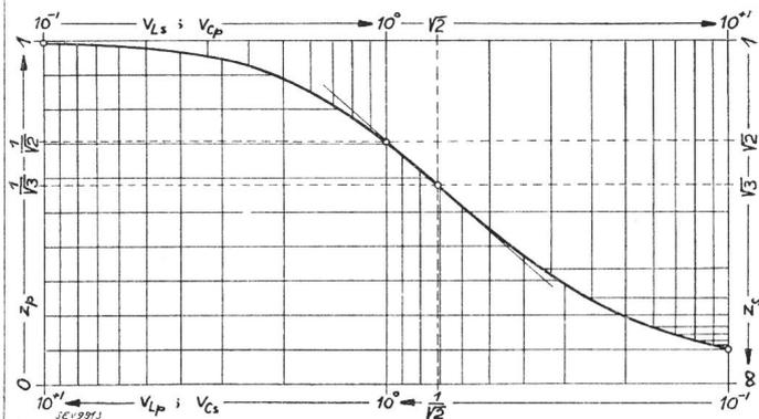
Fig. 5. Impedanzwerte bei logarithmischer Teilung für die Frequenzwerte.
