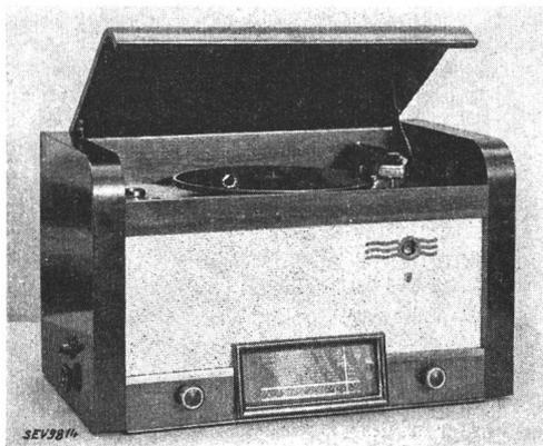
**Beschreibung:** Kombiniertes Radio-, Telephonrundsprach- und Grammophonapparat gemäss Abbildung. Apparat für den Empfang mittlerer und kurzer Wellen, für niederfrequenten Telephonrundsprach und Grammophonbetrieb. Lautstärkereglern, Tonblende und Programmwähltaste. Anschluss eines zweiten Lautsprechers möglich. Antrieb des Plattentellers durch Einphasen-Kurzschlussankermotor mit Geschwindigkeitsregler.
