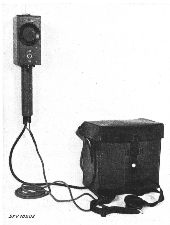
Fig. 2. UKW-Telephonie-Gerät für ca. 1,8 m Wellenlänge.
