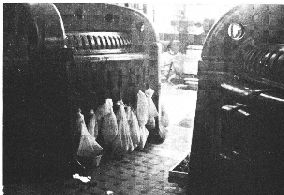
Fig. 4. Dörrgut in Säcken, die vor die Ventilationsöffnungen gehängt werden.
