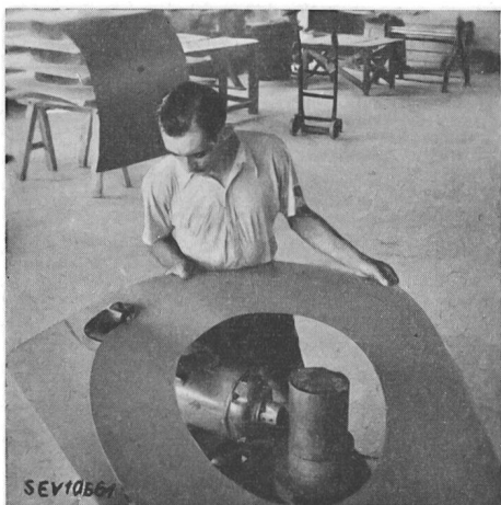
Fig. 1. Ausschneiden von Preßspan mit Blechschere
