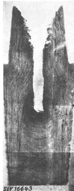
Fig. 6 Saugtrichter eines im Sand abgegossenen Stahlblockes (Baumannabdruck)
