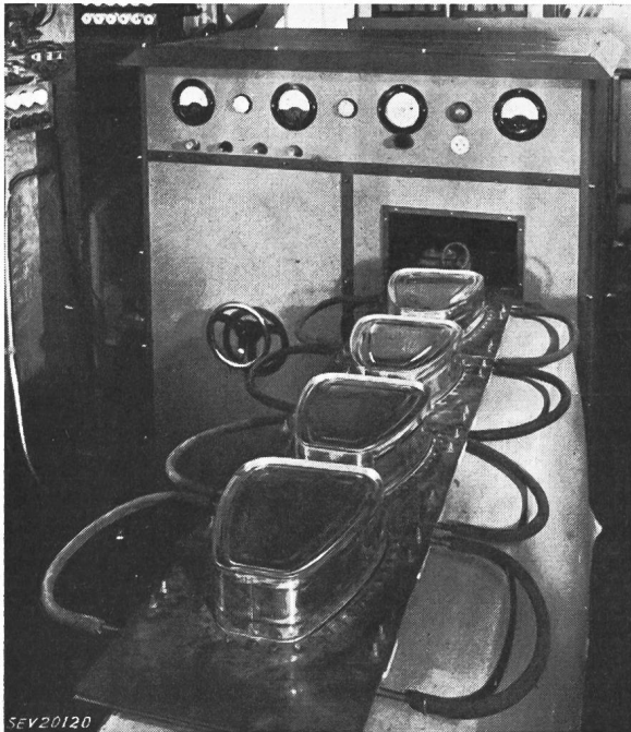
Fig. 10 Verlöten von Konservenhülsen Vier von den in Fig. 9 abgebildeten Kupferplatten werden in Serie als Arbeitsspule verwendet
