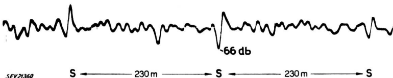
Fig. 20 Rückflußspannungen auf einem Koaxialkabel 2,64/9,52 mm, herrührend von einem \sin^2 -förmigen Sendeimpuls mit einer Halbwertzeit von 0,05 \mu\text{s} Abszisse: Entfernung vom Kabelanfang Ordinate: Rückflussschwankung A_r = 20 \cdot \log \frac{2 Z_0}{\Delta Z}
