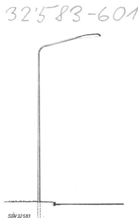
Fig. 1 Typenskizze des Stahlrohrmastes von 10 m Höhe Neigung des Auslegers 15°, Neigung der Leuchte 5°
