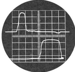
Dehnung in Abhängigkeit von der Zeit und Abstand in Abhängigkeit von der Dehnung, gemessen an einer Exzenterpresse
