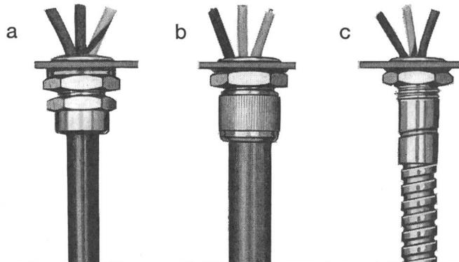
Sämtliche JJB-Verschraubungen garantieren einwandfreie und absolut sichere Anschlüsse. Sie sind schneller und praktischer zu montieren, da weder Löten, Bördeln noch Nieten nötig ist. (Dadurch sind sie auch jederzeit lösbar, wenn ein Kabel nachgezogen werden muss)
