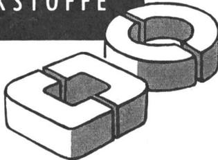
geben neue konstruktive Möglichkeiten und sind die geeignete Kernform für verlustarme Siliziumeisenwerkstoffe mit Vorzugsrichtung und hochwertige Nickeisen-Legierungen.
