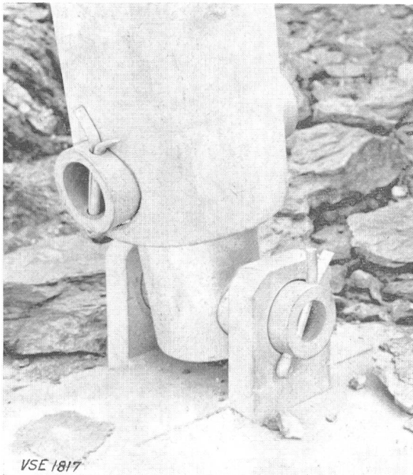
Fig. 3 Detail eines Kardangelenkes
