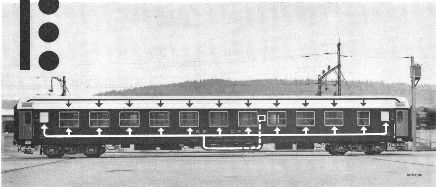
Dieser Liegewagen der SBB ist mit einer Brown Boveri Warmluftheizung (weisse Linie) ausgerüstet, entsprechend den RIC-Vorschriften, sowie mit zusätzlicher Lüftung (schwarze Linie) für den Sommer.
