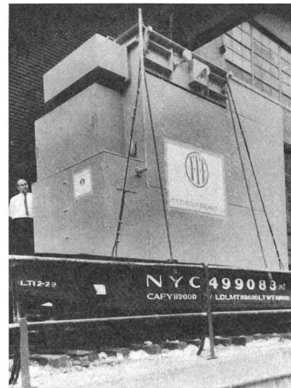
Fig. 16 ITE-Rectiformer für 75 kA bei 30 V
