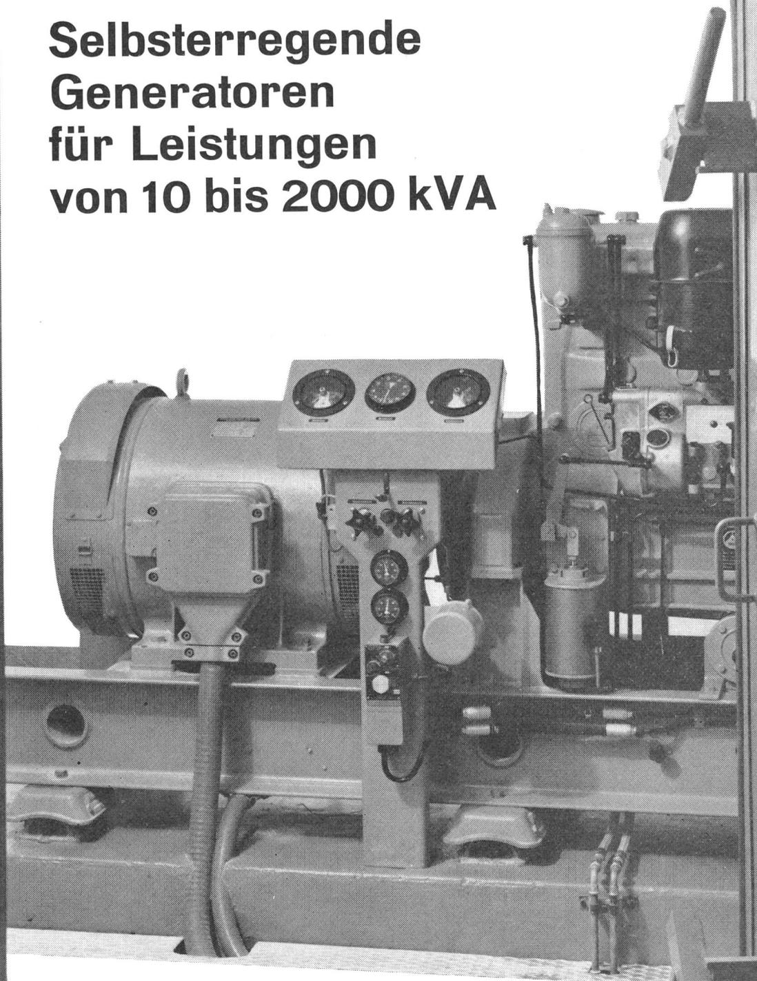
Betriebssichere, kompakte Bauart, ohne Kollektor. Statische Reguliergenauigkeit  $\pm 1,5 \%$  (bei  $\cos \varphi = 0,8 \dots 1$ ). Kürzeste Regulierzeit. Sichere Übernahme induktiver Lasten (Anlaufströme von Kurzschlussankermotoren). Bauformen B3, B2 oder B20
