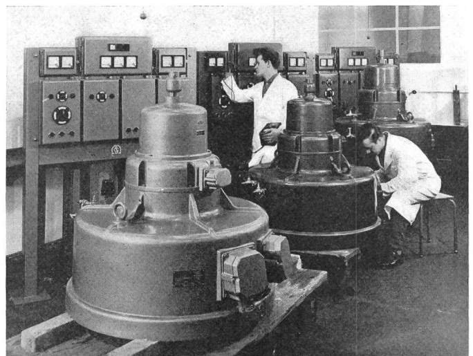
Fig. 4 Werkstatt-Abgleich von Maschinen-Generatoren mit der Grundfrequenz 20 kHz
