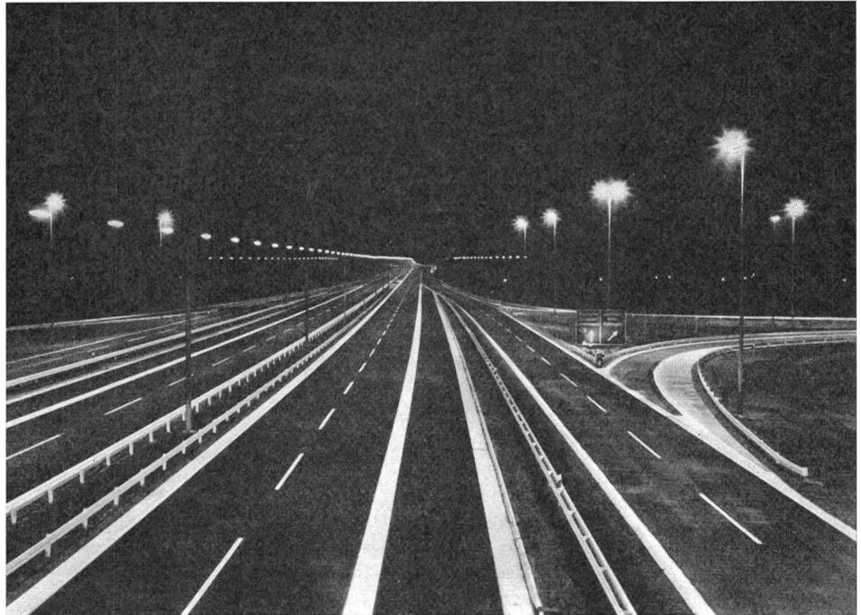
Die Leuchtenkette über den Mittelstreifen wird an der Strassenbrücke unterbrochen. Unter der Brücke sind in jeder Fahrtrichtung beidseitig schrägstrahlende Tunnelleuchten mit je einer Leuchtstofflampe 65 W angebracht.
