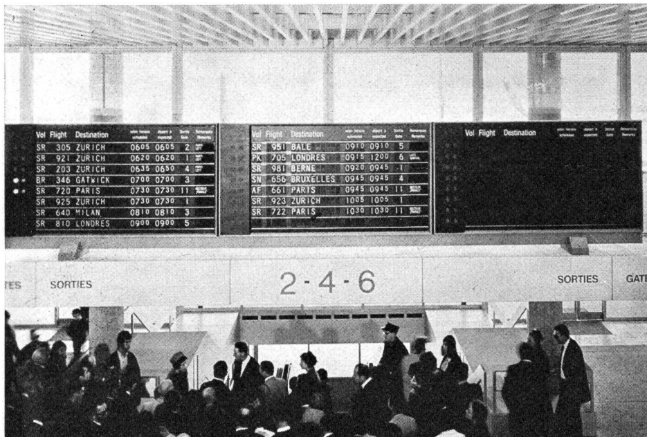
Fig. 10 Anzeigetafeln mit Einzelanzeigewerken für Buchstaben, Zahlen sowie Buchstaben plus Zahlen und gleich raschen Breitpalettenmeldern für stereotype Hinweise
