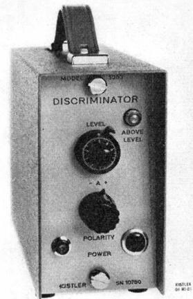
werden umgelegt. Mit dem Spannungsimpuls können elektronische Zähler angesteuert und bis zu 100 000 Grenzwertüberschreitungen pro Sekunde gezählt werden. Die Relaiskontakte schalten mit max. 50 Hz und dienen der Auslösung von Zähl- oder Steuervorgängen sowie für Signalzwecke.
