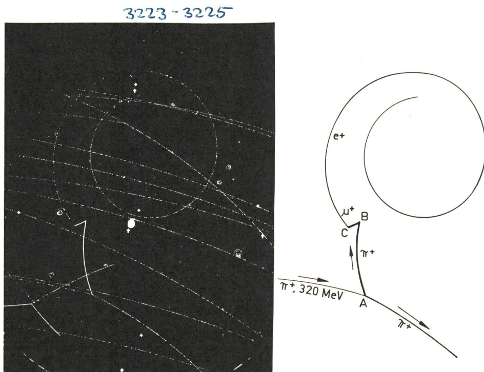
Fig. 1 Spuren von der Entstehung eines Pi-Mesons (A) und seiner Zerfallskette: Pi-Meson (A bis B) → Müon (B bis C) → Positron (Spiralbahn). Aufnahme in einer Wasserstoffblasenkammer der CERN
