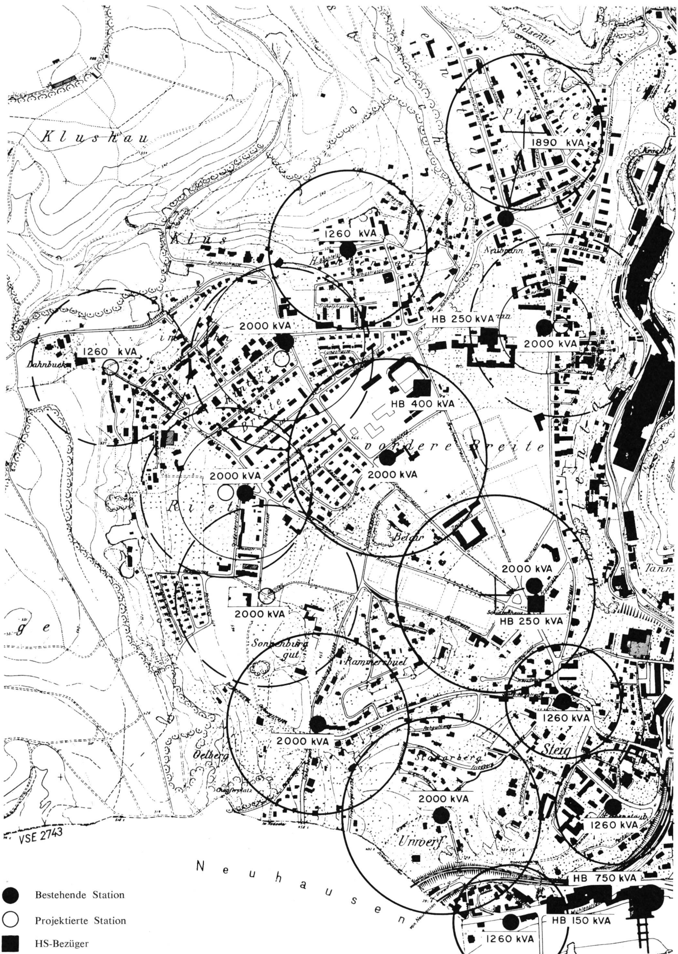
Fig. 1 Versorgungsradius von bestehenden und projektierten Transformatorstationen
