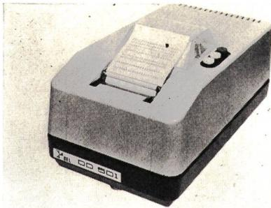
sich der Abdruck vorlaufender Nullen unterbinden. Der Zeichenvorrat umfasst die zehn Ziffern, fünf Symbole und «Blank». Alle Eingangsleitungen für die parallel eingegebenen 4-bit/Zeichen und die Druck- und Papiervorschubbefehle sind DTL/TTL-kompatibel.
