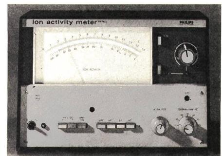
durchzuführen. Dies um so mehr, als auch die Eichlösungen einfach zuzubereiten sind. Selbstverständlich lassen sich mit dem Gerät auch pH-Werte und Redoxpotentiale messen. Ausserdem ist es auch für amperometrische Titrations eingerichtet.
