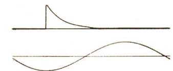
Fig. 4 Positive Schaltspannung im negativen Scheitel der Wechselspannung Schaltung gemäss Fig. 1b
