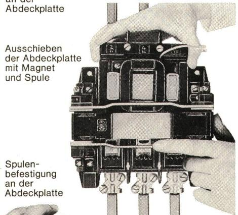
Ausschieben der Abdeckplatte mit Magnet und Spule
