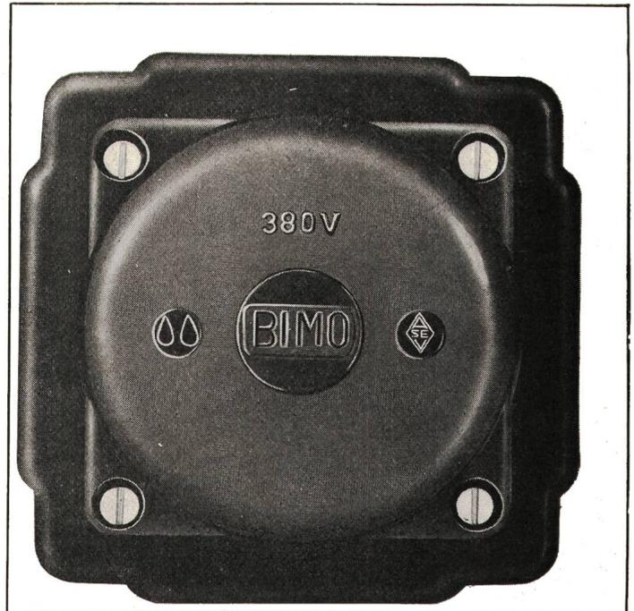
6 ausbrechbare Einführungen mit Gummidichtungen für Tdc-Kabel bis 4 x 2,5<sup>2</sup>, Steatitklemmeneinsatz mit Madenklemmen.
