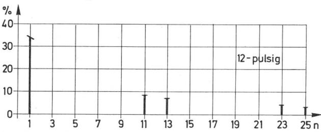
Fig. 6 Durch Zusammenschaltung von zwei symmetrischen Drehstrom-Brücken heben sich weitere Oberschwingungen bestimmter Ordnungszahlen auf (in Fig. die 5., 7., 17. und 19. Harmonische)
