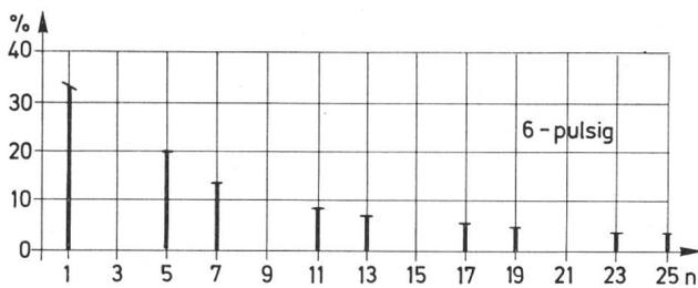
Fig. 5 Zweiweggleichrichter mit Drehstrom (6pulsige Schaltung): Die Oberschwingungen mit durch drei teilbaren Ordnungszahlen treten nicht auf
