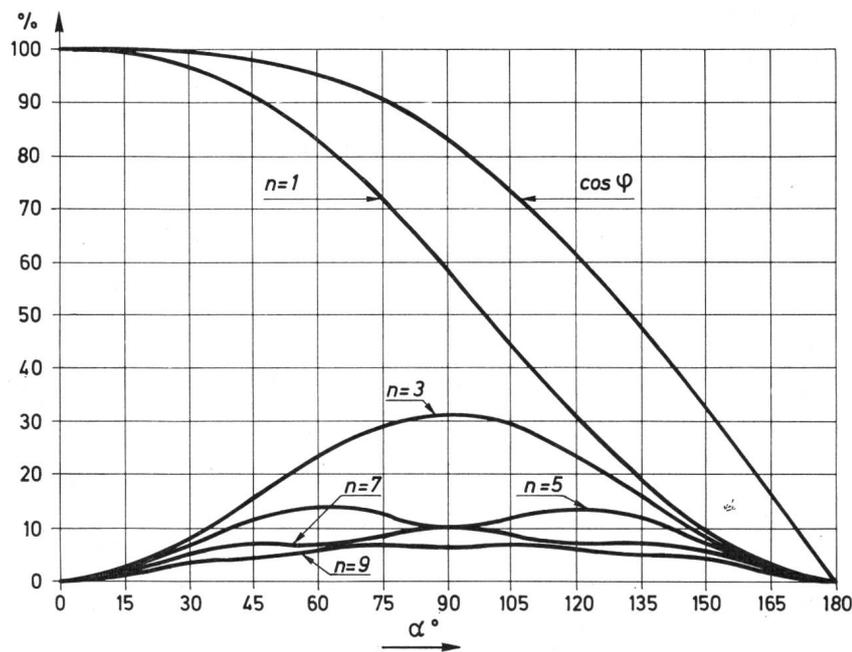
Fig. 3 Amplitude der bei symmetrischem Anschnitt und ohmscher Belastung entstehenden Oberschwingungen und Verschiebungsfaktor  $\cos \varphi$  in Abhängigkeit des Anschnittwinkels  $\alpha$
