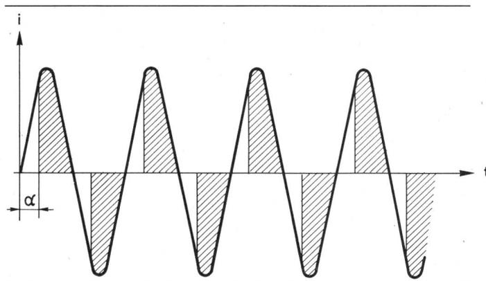
Fig. 2 Phasenanschnitt-Steuerung
