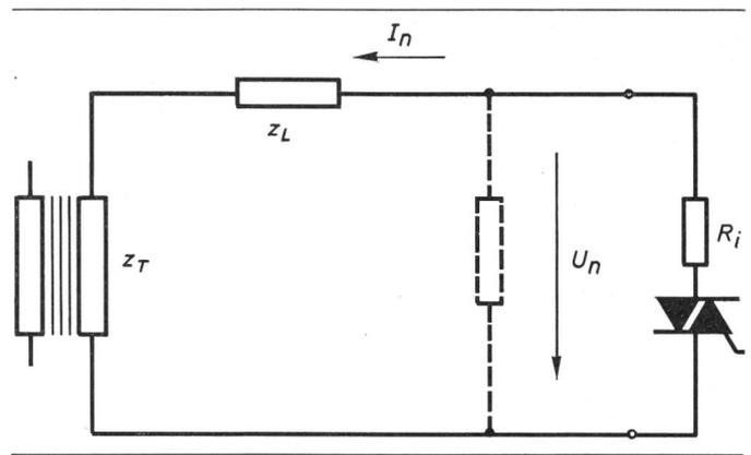
Fig. 7 Zweipoliges Ersatzschema des Niederspannungsnetzes mit Verbraucher
