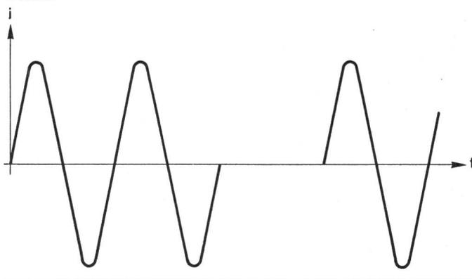
Fig. 1 Schwingungspaket-Steuerung
