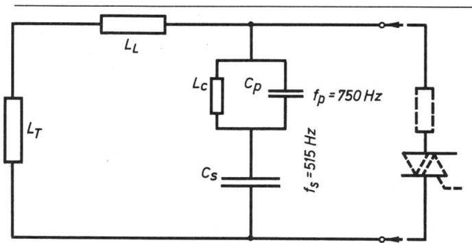
Fig. 8 Einfluss eines gesperrten Kondensators auf die Netz-Reaktanz
