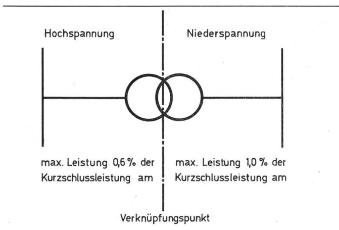
Fig. 11 Einsatz von Geräten mit Anchnittsteuerung
