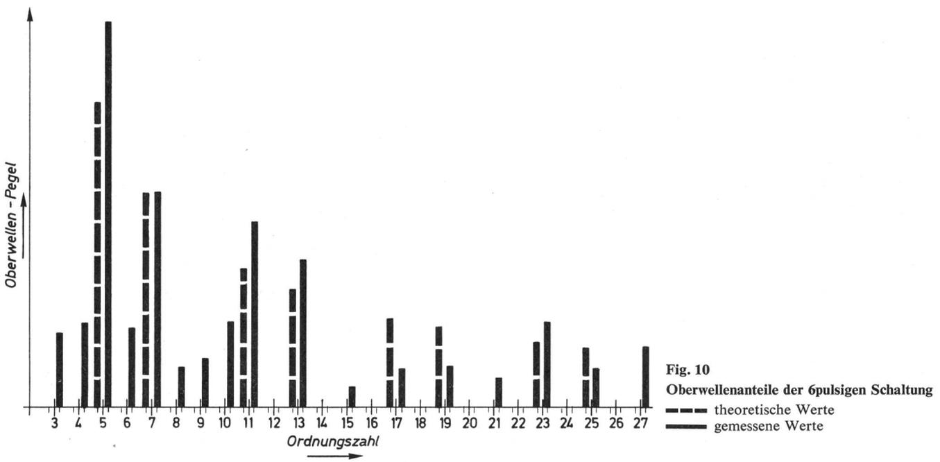
Fig. 10 Oberwellenanteile der 6pulsigen Schaltung
