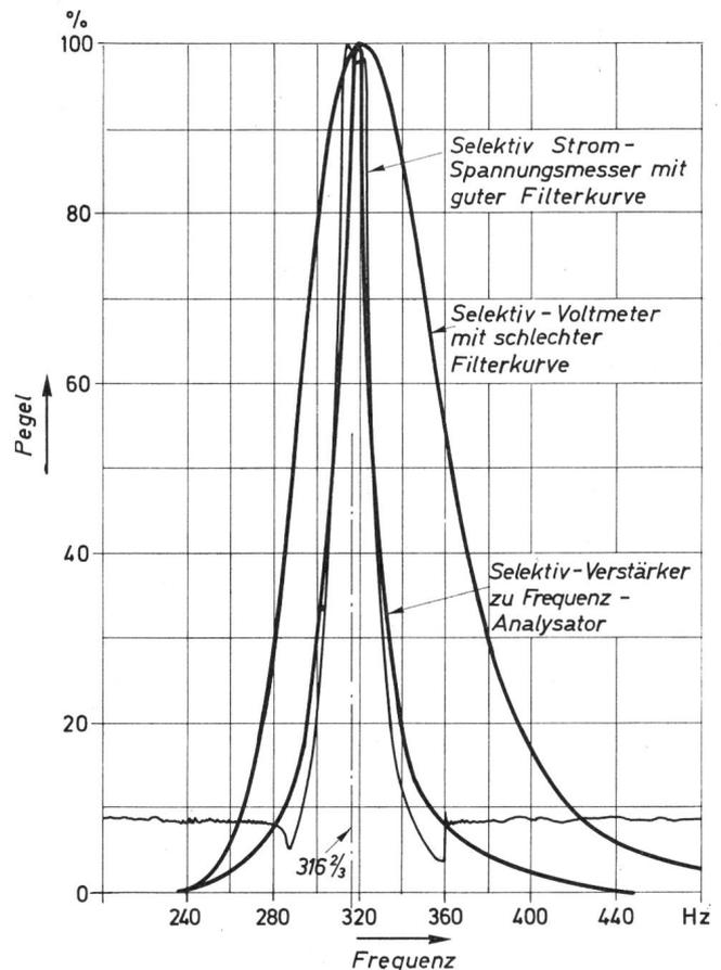
Fig. 8 Gute und schlechte Durchlasskurven verschiedener Oberwellenmessgeräte
