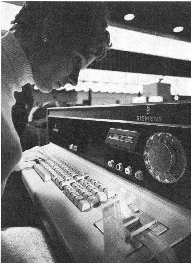
Fig. 4 Datenstation Fernschreiber 200 für Schreibgeschwindigkeiten bis 200 bit/s, CCITT, Code Nr. 5
