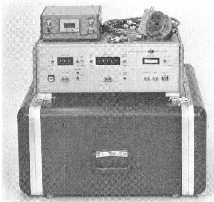
vergrössert werden. Das Messgerät besteht grundsätzlich aus einem Wobbelgenerator mit vielgestaltigen Funktionen und einem Auf- und Ab-Umsetzer. Es erlaubt viele der erwähnten Geräte zu erweitern, so z. B. erlaubt es das Messen von Verzerrungen bis in das Mikrowellengebiet, die Messungen von Gruppenlaufzeiten, Rauschen usw. an Empfängern, Sendern, Mikrowellenbauteilen, Baugruppen und anderes mehr.
