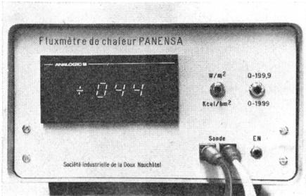
fage, d'entrepôts frigorifiques et en médecine pour le contrôle thermique de créatures vivantes. En laboratoire il peut être utilisé pour déterminer la conductibilité thermique des matériaux d'isolation et des matériaux de construction ainsi que dans les calorimètres.
