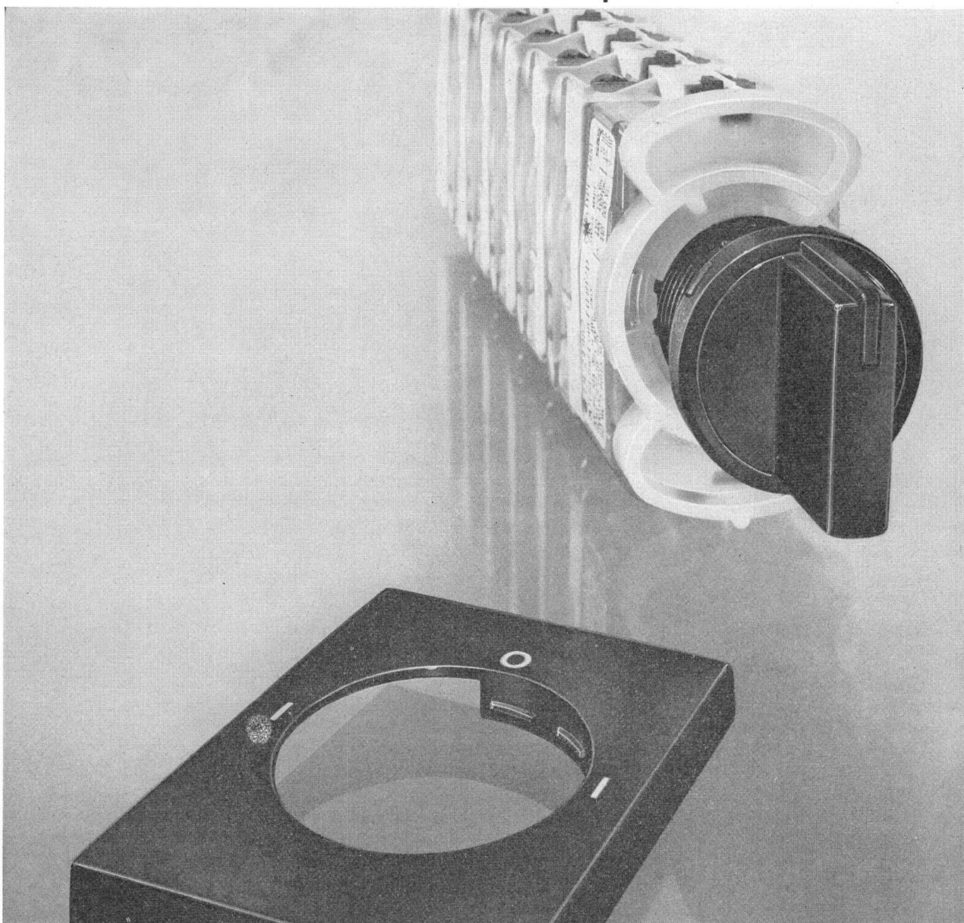
Der neue Nockenschalter DD 7300 ermöglicht universelle Schaltfunktionen. Jeder Kontakt wird von einer separaten Nockenscheibe betätigt. Dadurch können die Kontakte unabhängig voneinander in jeder Schaltstellung offen oder geschlossen sein.
