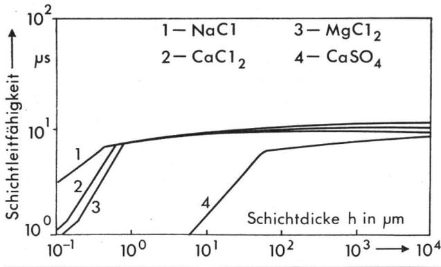
Fig. 3 Fremdschichtleitfähigkeit in Abhängigkeit der Schichtdicke für verschiedene Verunreinigungen, gemessen bei 18 °C, Salzbelag 0,1 g/m<sup>2</sup> [6]
