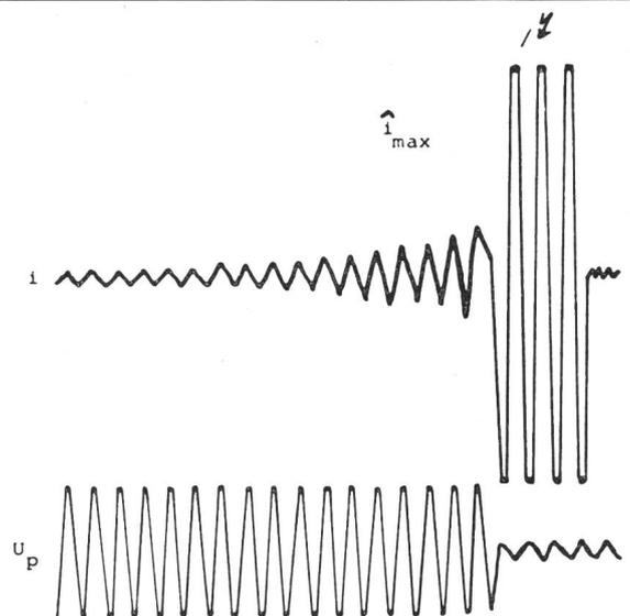
Fig. 14 Oszillogramm eines Fremdschicht-Überschlages
