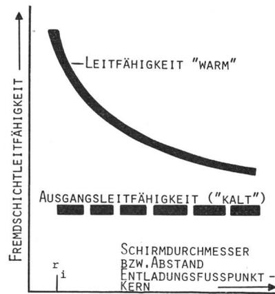
Fig. 4 Oberflächenleitfähigkeit in Abhängigkeit des Schirmdurchmessers Die Fusspunkte der Entladung wandern nach dem Rand der Schirme, wo es u. U. zum Überschlag von Schirm zu Schirm kommen kann.
