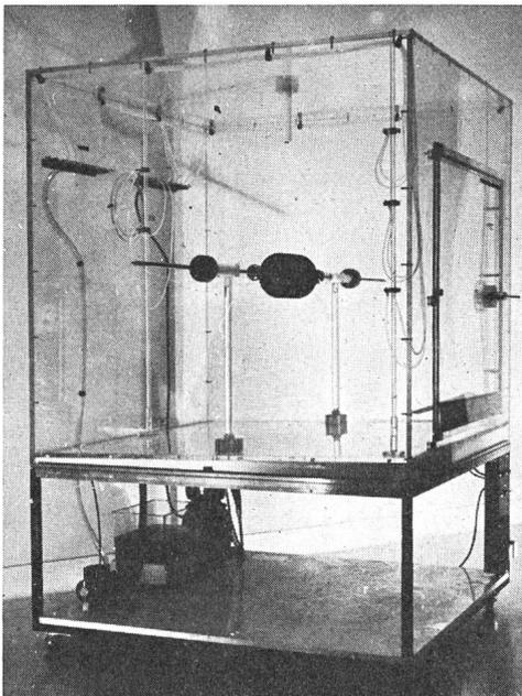
Fig. 13 Aus Plexiglas aufgebautes «Prüfzelt» für die Prüfung von Isolatoranteilen und kleineren Objekten im Nebel oder Salznebel
