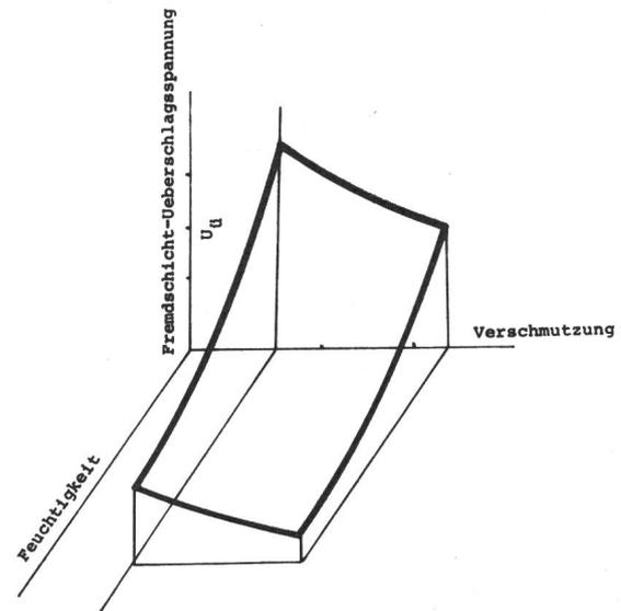
Fig. 8 Dreidimensionale Darstellung des Fremdschichtverhaltens einer Isolatoreinheit [10]
