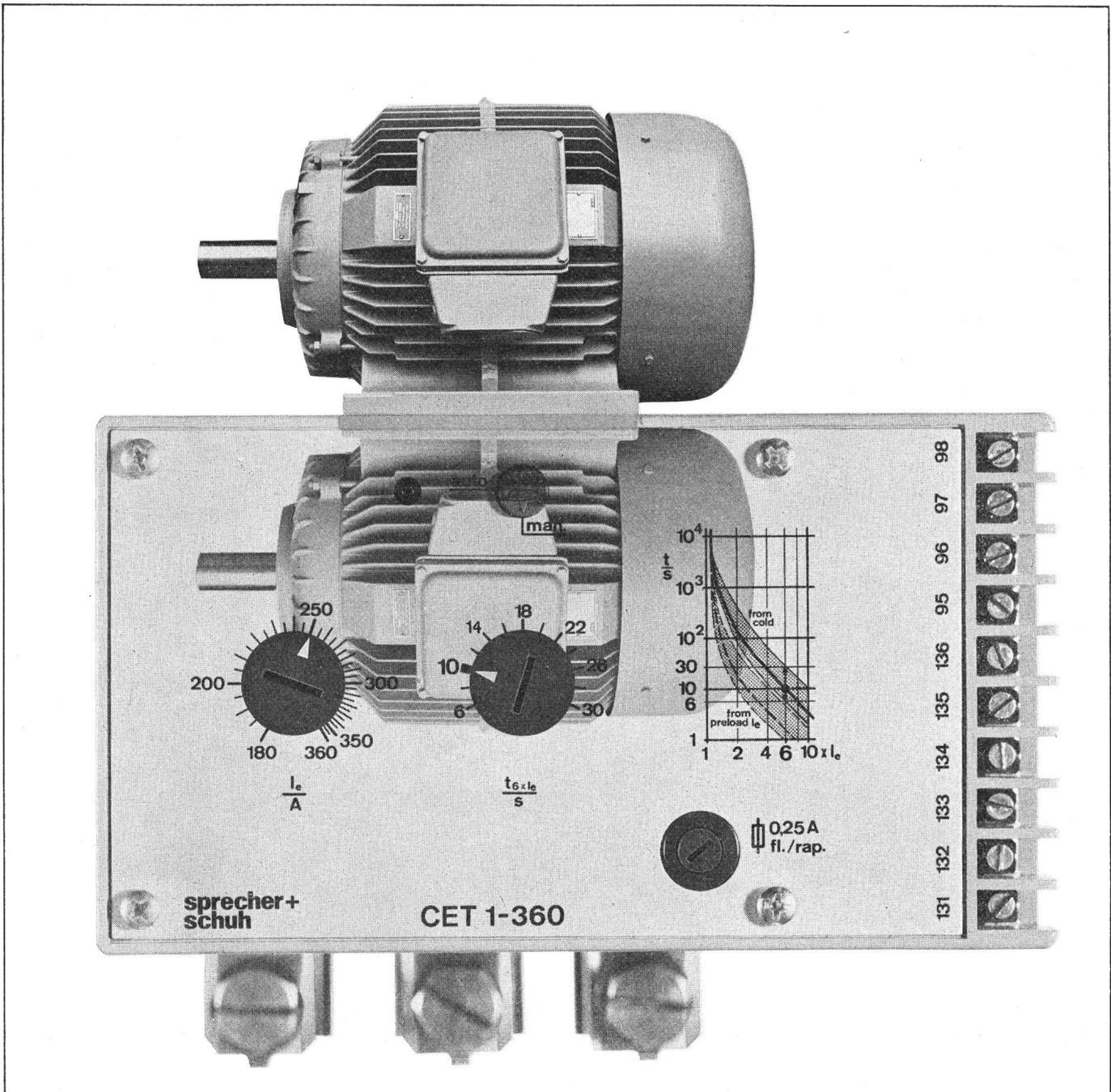
Das im CET enthaltene thermische Abbild ermöglicht den Schutz des Motors gegen Überlastung auch in schwierigen Betriebsarten, wie bei Schweranläufen oder intermittierendem Betrieb. Gleichzeitig erlaubt es eine gute Ausnutzung der Überlastbarkeit des Motors.
