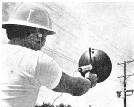
rungen von Übertragungsleitungen. So kann die Fehlerquelle exakt geortet werden.
