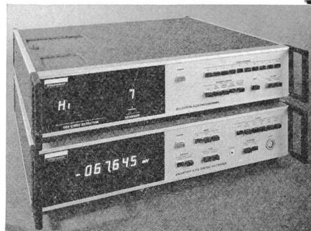
stung von bis 10 Meßstellen. Diese können je mit steckdiodenprogrammierbaren Grenzwerten verglichen werden. Die Messwerte, reduziert oder unbehandelt, können auf alle üblichen Datenträger ausgegeben werden.
