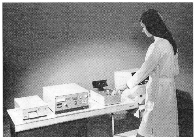
Fig. 6 Photometer-Arbeitsplatz mit Probenröhrchen-Leser, Messwert-Vorverarbeitungseinheit und Drucker
