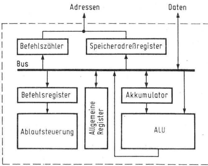
Fig. 1 Blockschaltbild eines Mikroprozessors
