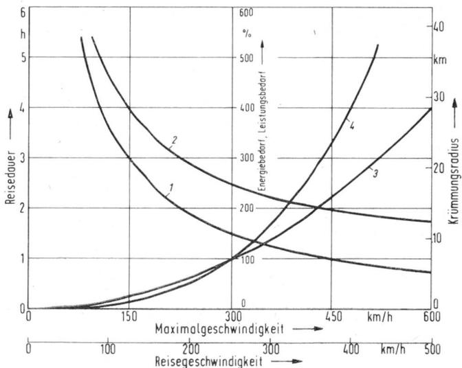
Fig. 1 Einfluss der Geschwindigkeit auf Reisedauer, Energiebedarf, Krümmungsradius und Leistungsbedarf
