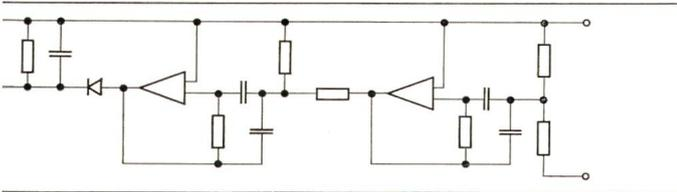
Fig. 3 Prinzipschema eines Aktivfilters für Rundsteuerempfänger
