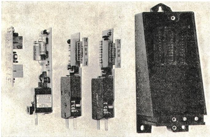
Fig. 6 Baugruppen des Decabit-Empfängers RE 2/2, von links nach rechts:
