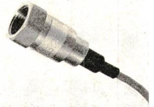
$\frac{3}{8}$ " Gasrohrgewinde. Druckbereiche 0...2 bis 0...400 bar. Genauigkeit 0,2...0,5 %. Hohe Stabilität und Eigenfrequenz, Auflösung von 0,1 mbar. Das robuste Gerät ist für Einsatz in extremen Umweltbedingungen geeignet. Temperatureinsatz von -40...120 °C.
