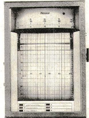
Widerstandsthermometer, Thermolemente oder Geber mit Strom-, Spannungs- oder Widerstands Ausgang. Der Meßstellen-Umschalter ist mit speziellen Goldkontakten bestückt und in einem vollgekapselten Gehäuse untergebracht. Der Papierantrieb erfolgt durch einen Synchronmotor für 220 V oder 24 V. Die Schreiber können mit Minima- und Maxima-Grenzkontakten ausgerüstet werden und sind lieferbar für Schalttafeleinbau und als tragbare Geräte.
