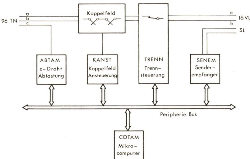
**Fig. 2** Hardwareaufbau des Konzentrators
