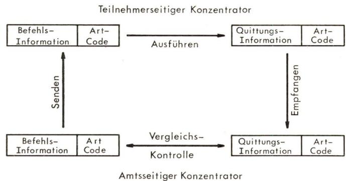
Fig. 8 Fehlererkennung bei der Informationsübertragung
