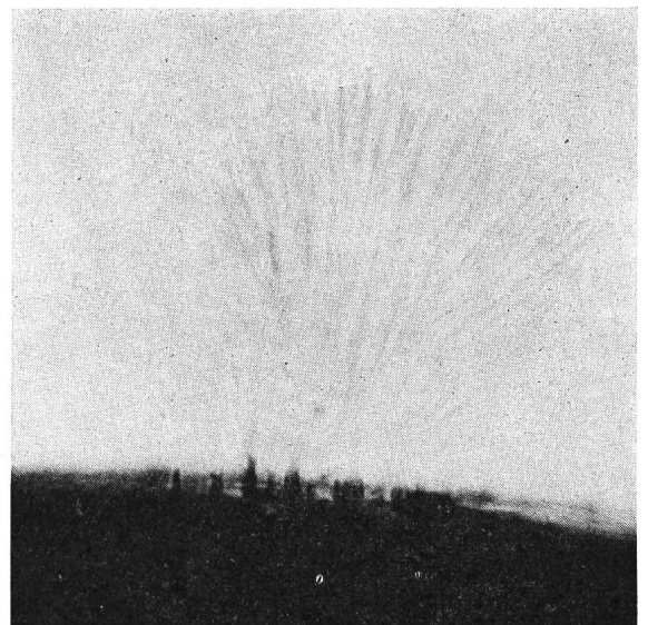
Fig. 10 Arborescences d'humidité dans un isolant
