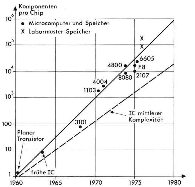
Fig. 1 Entwicklung der Komponentendichte pro Chip
