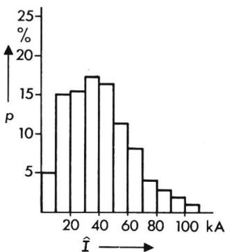
Fig. 2 Histogramme des amplitudes des courants de foudre
