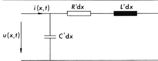
Fig. 5 Schéma équivalent d'un élément de ligne
