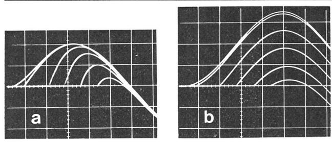
Fig. 4 Stromverlauf nach dem Einschalten bei verschiedenen Einschaltmomenten
