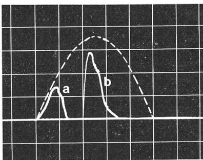
Fig. 9 Abschaltung eines Kurzschlußstromes von 2500 A ( $\cos \varphi \approx 1$ ) durch einen Schalter mit einer Lichtbogenspannung von 350 V
