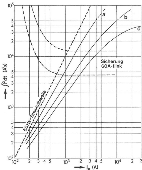
**Fig. 12** Durchlassenergie in Funktion des Kurzschlußstromes verschiedener Leitungsschutzschalter gemäss Fig. 8 sowie Schmelzenergiestreuband der flinken Normalleistungssicherung 60 A
