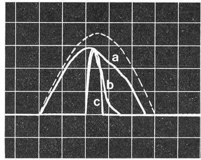
**Fig. 13** Abschaltung eines Kurzschlußstromes von 2500 A ( $\cos \varphi \approx 1$ ) durch Schalter verschiedener Lichtbogenspannung im für den betreffenden Schalter ungünstigsten Entstehungsmoment des Kurzschlusses
