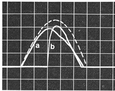
Fig. 7 Abschaltung eines Kurzschlußstromes von 2500 A ( $\cos \varphi \approx 1$ ) durch einen Schalter mit einer Lichtbogenspannung von 150 V
