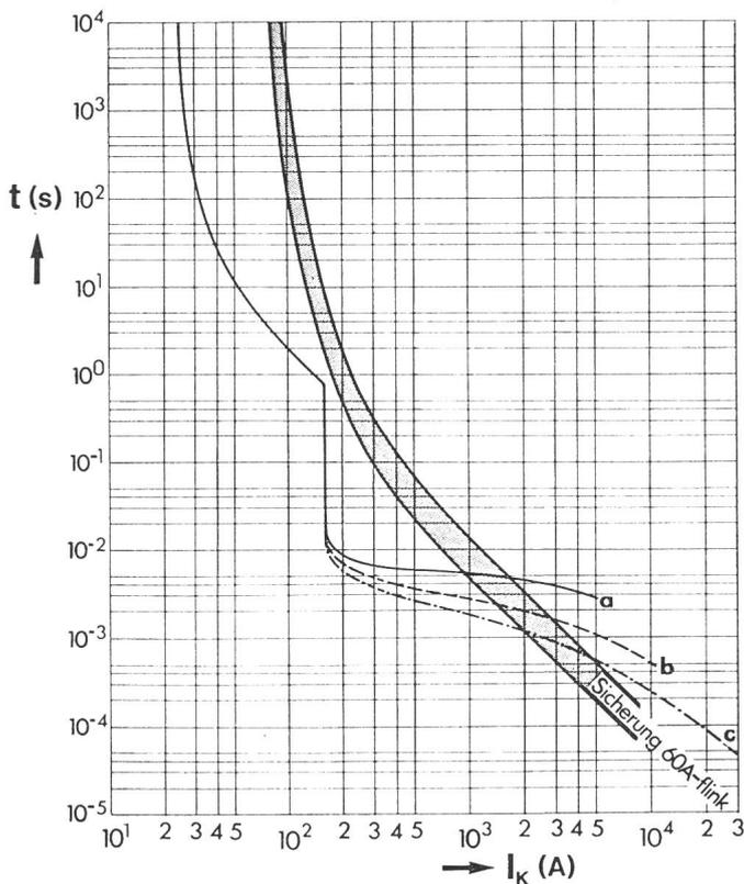
Fig. 14 Auslösekennlinie von 16-A-Leitungsschutzschaltern mit verschiedenen Lichtbogenspannungen sowie Auslösekennlinie der flinken Normalleistungssicherung 60 A
