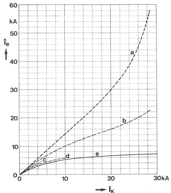
Fig. 15 Grösstmögliche Scheitelwerte von Kurzschlußströmen in Abhängigkeit des Effektivwertes des Kurzschlußstromes
