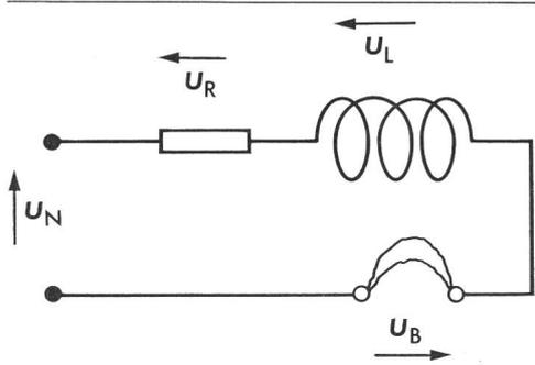
Fig. 6 Ersatzschema eines einphasigen Stromkreises während der Abschaltung
