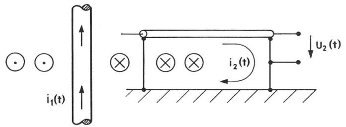
Fig. 4 Induktion eines Stromes  $i_2(t)$  im Mantel eines Koaxialkabels durch das Magnetfeld eines Stromes  $i_1(t)$
