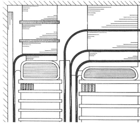
**Fig. 3 Feinbarrieren-Isolation aus Transformerboard (2...3 mm dick)**
