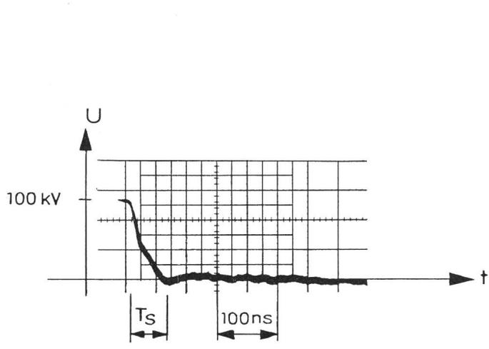
Fig. 1 Spannungszusammenbruch beim Durchschlag einer Kugelfunkstrecke (ohne Überspannung) in Luft bei 1 bar
