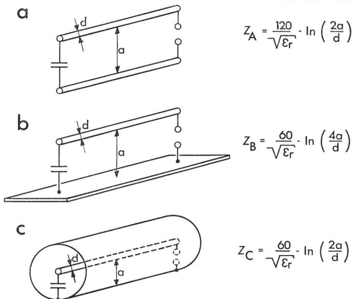
Fig. 12 Wellenwiderstände von Anordnungen mit unterschiedlichem Abschirmungsaufwand
