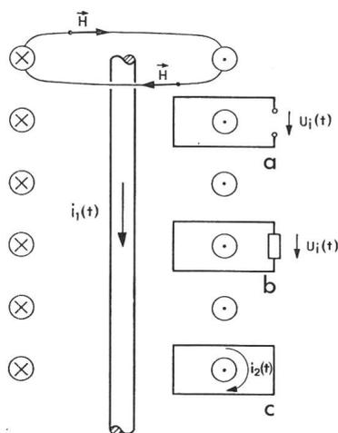
Fig. 2 Zur Induktion durch das Magnetfeld eines stromführenden Leiters
