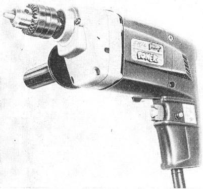
geschwindigkeit in den verschiedenen Materialien, auch Glas, gewölbten Flächen; Schlagbohren in härtestem Beton, ebenfalls mit stufenloser Drehzahlregulierung; Schrauben ein- und ausdrehen; Gewindeschneiden. Technische Daten: 10-mm-Bohrfutter; unbelastete Dreh- und Schlagzahl 0...2600/0...36 000 pro Minute; Leistungsaufnahme 380 W; Nettogewicht 2 kg.
