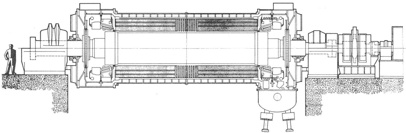
Fig. 3 Coupe d'un turbo-alternateur de 1500 MVA [3]
