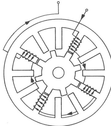
Fig. 8 Moteur pas à pas réluctant triphasé
