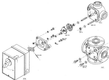
einem Stellantrieb und Heizungsregler. Dabei ist das Nachrüsten und Automatisieren von Hahnen durch die problemlose Montage der Anbausätze denkbar einfach: einfach stecken und schrauben. Die Hahnen sind nicht auszuwechseln, was auch beim Ersatz ausgedienter Antriebe und Regler wichtig ist.
