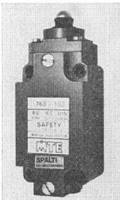
Gehäuse dieser Schalter rot gespritzt. Das leistungsfähige Schaltelement der Grenztaster MTE ist mit einem zwangsöffnenden sowie einem Arbeitskontakt ausgerüstet und in einem soliden Spritzgussgehäuse der Schutzart IP 65 eingebaut. Von Vorteil ist auch der grosse Nachlaufweg des Tastelementes.
