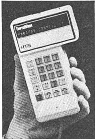
der Anzeige-Buffer hat 940 Zeichen. Das HT/7 besitzt eine Anzeige von 40 alphanumerischen Zeichen auf zwei Linien; der Anzeige-Buffer hat 960 Zeichen. Auf dem HT/8 können vier Linien mit 20 Zeichen angezeigt werden; 1000 Zeichen können im Buffer des Anzeigemoduls gespeichert werden.
