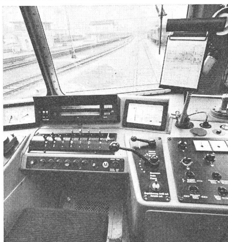
Fig. 9 Eingliederung des Anzeigegerätes im Führerstand (Re4/4 II )
