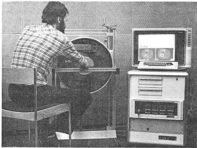
Fig. 5 Photographie eines \gamma -Strahlen-Computertomographen
