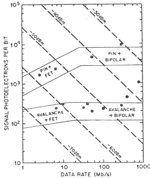
Fig. 8 Empfindlichkeit optischer Empfänger für verschiedene Datenraten
