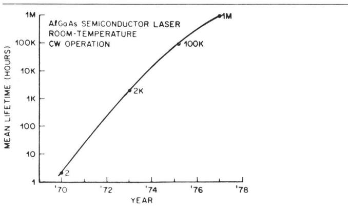
Fig. 2 Verbesserung der Zuverlässigkeit von AlGaAs-Injektionslasern [14]
