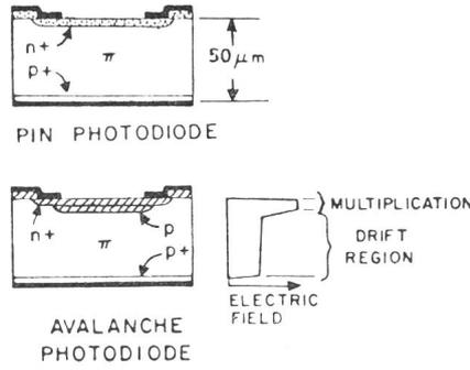
Fig. 7 Querschnitt durch Silizium-p-i-n-Photodiode und n<sup>+</sup>-p- $\pi$ -p<sup>+</sup>-Avalanche-Photodiode
