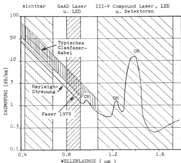
Fig. 1 Optische Dämpfung von Glasfaser-Lichtwellenleitern
