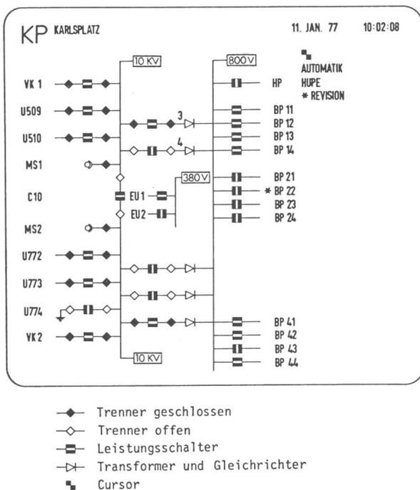
Fig. 2 Beispiel für ein Unterstations-Bild
