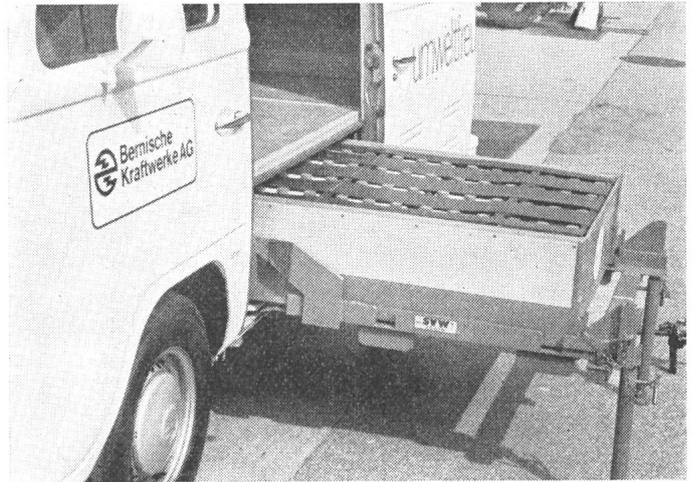
Fig. 2 Batterieeinheit des VW-Transporters der BKW
