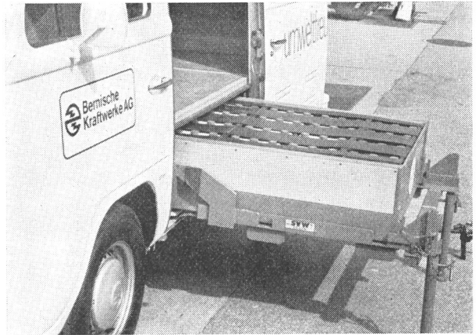
Fig. 2 Batterieeinschubeinheit des VW-Transporters der BKW
